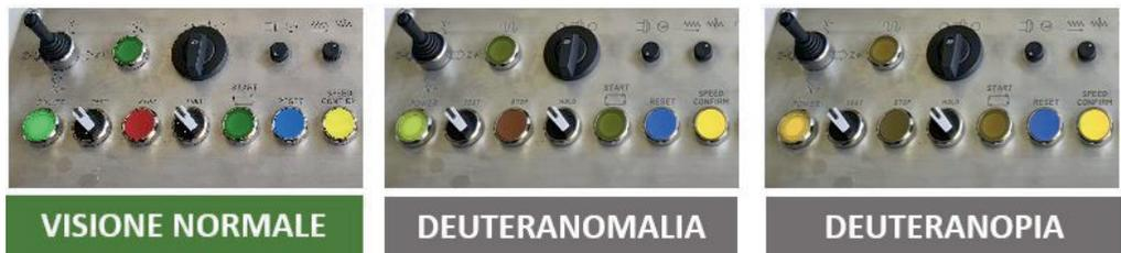
Figura 12 - Pulsante luminoso e alterazione cromatica
